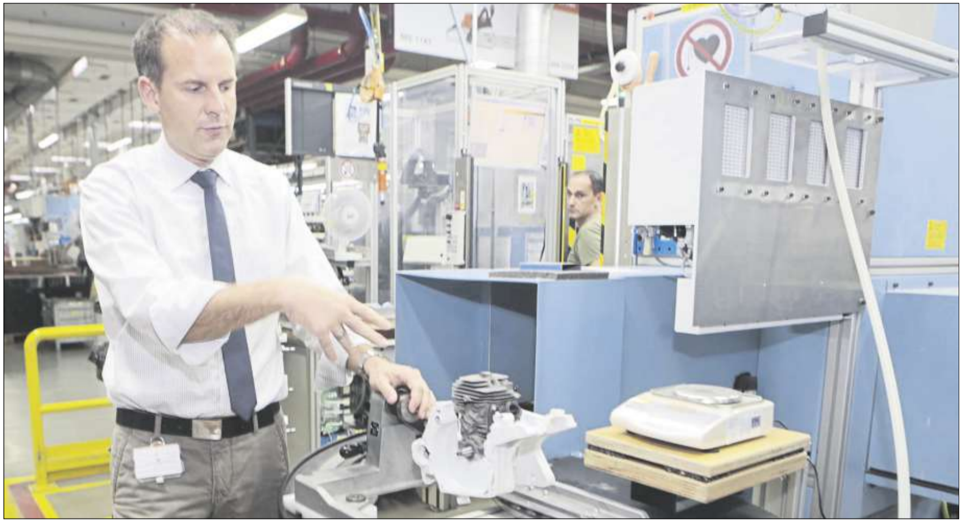
Werkzeugträger an den Montagelinien tragen RFID-Chips, die mit allen notwendigen Infos für die Produktvariante beschrieben und an jeder Arbeitsstation gelesen werden können (im Bild: Martin Treitz, Leiter Montage Center 1 des Stihl-Werks 2 in Neustadt, zeigt einen solchen Werkzeugträger). Bild: Bernhardt
